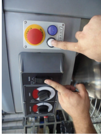
Fig. 17 - Foto do acionamento do botão ABRIR e o do botão TACHO para baixo . Para subir o recipiente: Pressione o botão ABRIR e o botão TACHO para cima ao mesmo tempo.
